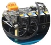
**Interface sur une carte programmable** de type « Arduino » ou compatibles. Les capteurs et les actionneurs sont câblés directement sur la carte qui sert aussi d'interface.
