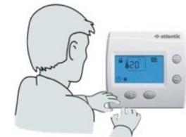
**Boitier (pupitre) de commande** du thermostat du chauffage d'une maison (centrale d'ambiance) assurant l'**interface Homme-machine**.
